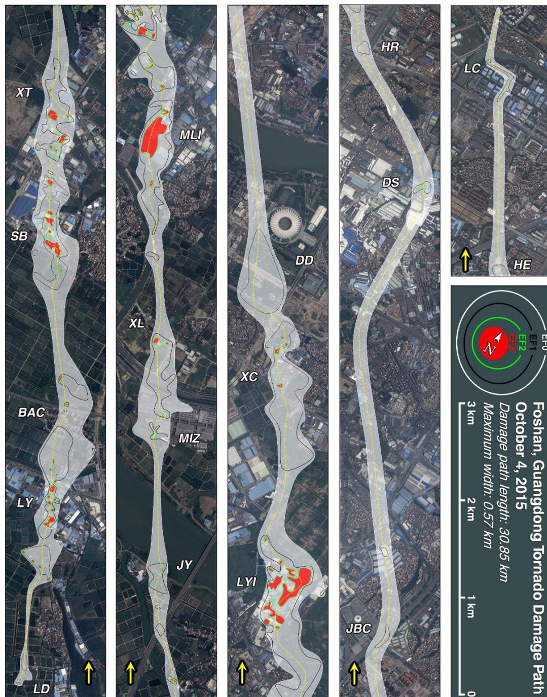
图 3.4 佛山 TC 龙卷的地面灾害等级分布图。白色、黑色、绿色和红色分别代表 EF0、EF1、EF2、和 EF3 级；黄色虚线代表龙卷移动路径；黄色箭头表示龙卷移动的大致方向。背景图来自 Google Earth 卫星照片。
